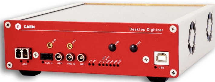
Figura 2: Digitalizador de señales del kit premium CAEN.
