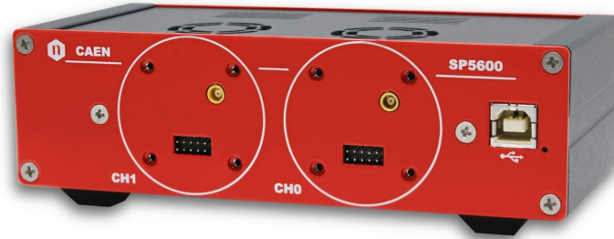
Figura 1: Fuente de poder y amplificación del kit premium CAEN.
